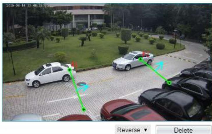
*Les deux barrières virtuelles sont dans un ordre séquentiel. Une alarme est générée uniquement lorsque la cible traverse la barrière virtuelle 1 puis la barrière virtuelle 2 dans le délai de passage maximum réglé.*
