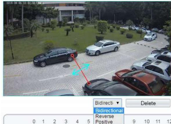
*Une barrière virtuelle simple n'est pas dans une zone de déploiement, par conséquent, lorsqu'une alarme est générée, la trace existe toujours. La trace disparaît seulement lorsque l'objet cible se déplace hors du champ de vision. Essayez de dessiner la barrière virtuelle simple au milieu, car la reconnaissance d'une cible prend du temps après qu'elle soit apparue à l'écran et une alarme est générée uniquement lorsque l'objet est reconnu pour avoir franchi la barrière virtuelle simple.*
