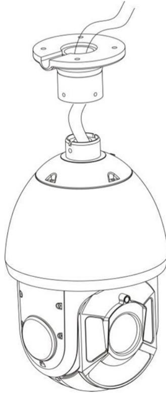
Fixez la caméra au plafond et serrez les 4 vis complètement
