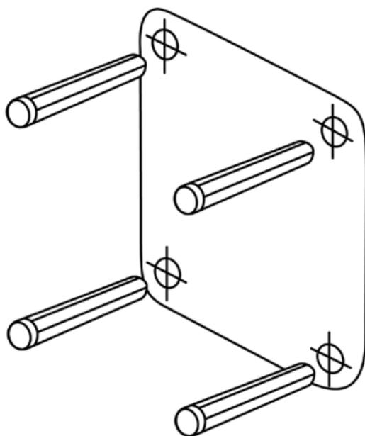
Fixez la caméra avec les vis adaptées à l'emplacement prévu et retirez le film plastique.
